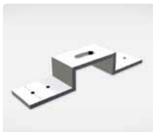
Quick-Line Hutprofilhalter ; 40 x 180 mm, zum Aufschrauben oder Nieten, AlMg0,7SiF25
