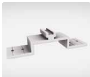
Quick-Line Einschubhalter ; schwimmende Verlegung auf Trapez, 40 x 150 mm, zum Aufschrauben oder Nieten, AlMg0,7SiF25
