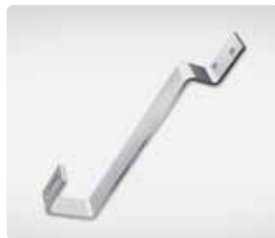
Quick-Line Dachhaken Biberschwanz ; 30 mm breit, 350 mm lang, Edelstahl 1.4301
